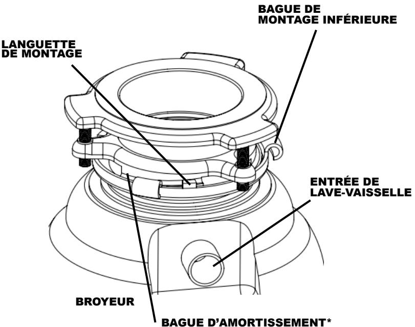
**REMARQUE :** une bague d'amortissement est comprise entre les bagues de montage supérieure et inférieure.
