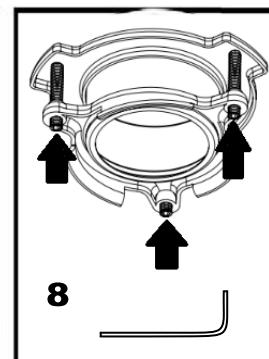
c. S'assurer que l'évier est propre. Enduire le rebord inférieur du collet d'évier de mastic de plomberie (1). À l'intérieur de l'évier, pousser le collet dans le drain de façon à bien le sceller (2). Une fois que le collet est en place, NE PAS LE DÉPLACER OU LE TOURNER pour éviter de briser le mastic.
