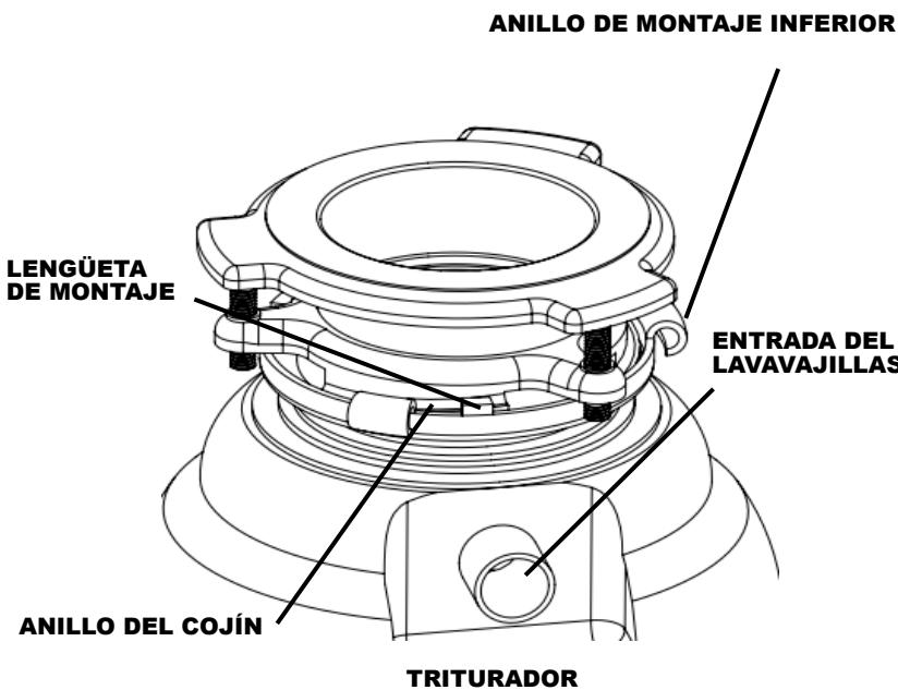
**NOTA:** El cojín del anillo está incluido entre el anillo de montaje superior y el anillo de montaje inferior.
