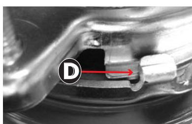
**Levante y gire el anillo de montaje inferior en sentido contrario al de las manecillas del reloj hasta que las tres lengüetas de montaje se encuentren pasando las crestas (F) en los bordes de las rampas deslizables (D) del anillo de montaje superior.**
